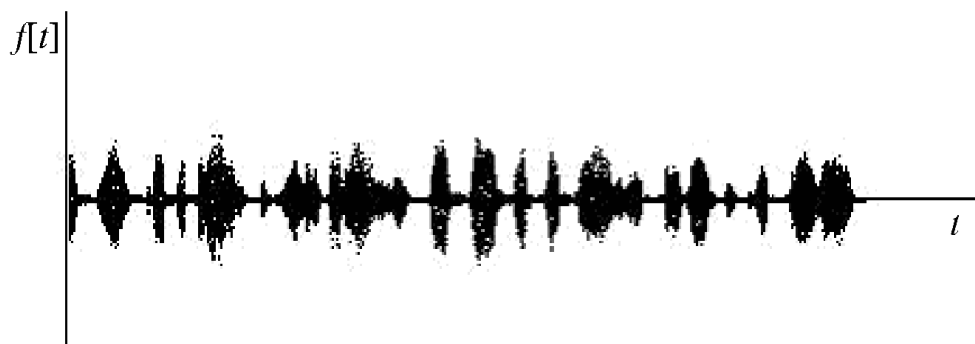
Рис. 8.8. Временная диаграмма звукового потока речи
