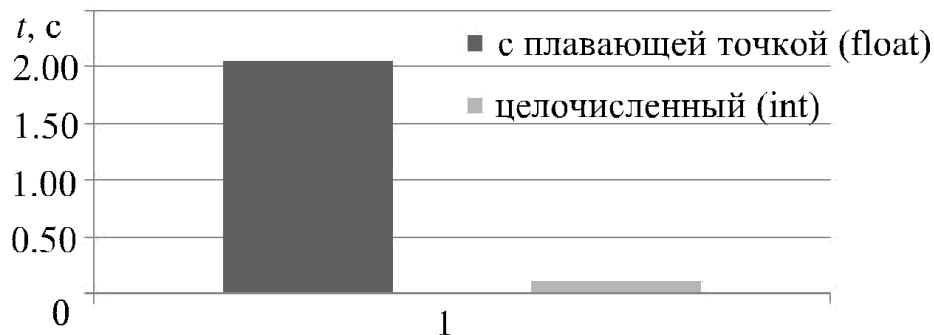
Рис. 2.6. Скорость вычисления преобразования цветовых пространств, изображение размером 4000×2000
