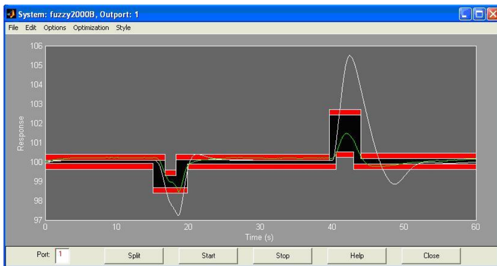
Рис. 2-22. Процесс оптимизации нечеткого нейронного регулятора в NCD-Blockset в системе регулирования с УВВ
