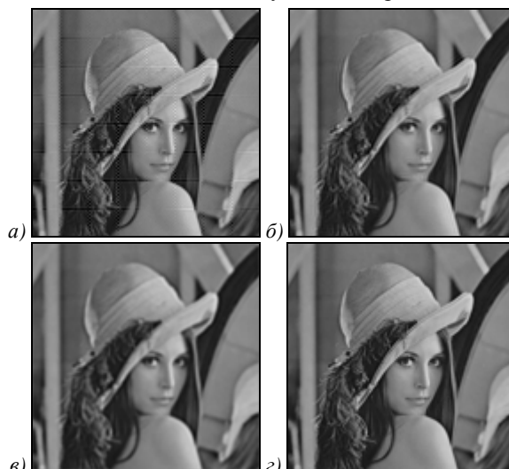
Рис. 7. Повышение разрешения в 4 раза: (а) результат применения фильтра Калмана; (б) результат применения метода ИОП; (в) результат применения метода МП; (г) оригинальное изображение BP
