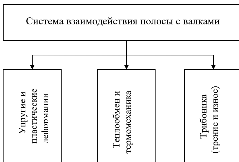
Рис. 1. Блок-схема триботермомеханической системы
