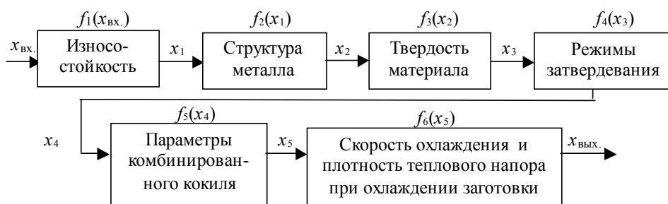
Рисунок 1 – Структура технологического процесса изготовления гильз цилиндров с повышенными износостойкими свойствами
