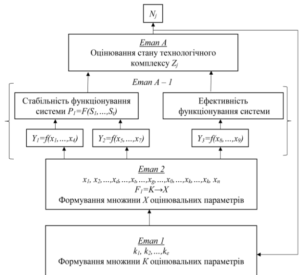
Рис. 3. Загальна структурна модель процесу оцінювання ефективності процесу формоутворення заготовок на вібропресовому обладнанні з гідроімпульсним приводом
